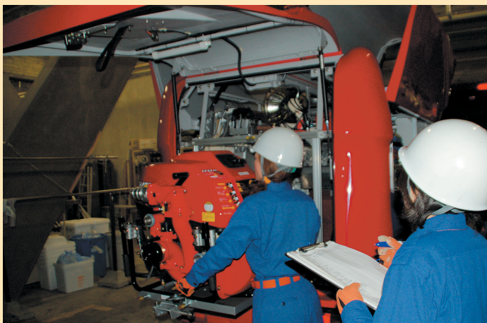
デージー分団 資機材(小型動力ポンプ)の点検(デージー分団)
